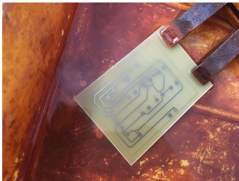
FIGURE 3.4 – L'immersion du circuit imprimé des boutons
